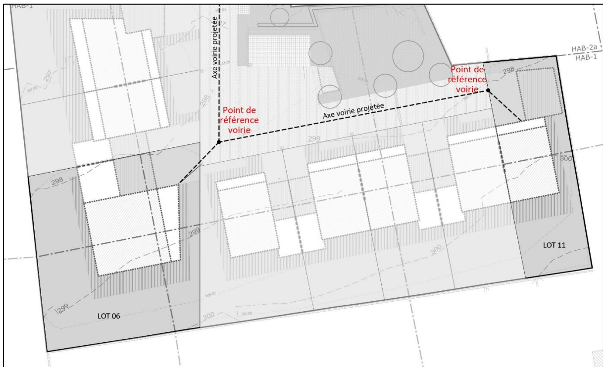
Image 2 : Croquis explicatif pour la définition de la hauteur à l'acrotère du lot 06 et du lot 11
